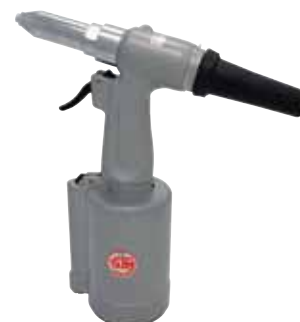
REMACHADORA NEUMÁTICA YAIM Capacidad de remache en aluminio hasta 5 mm. Se suministra con un maletín que contiene: boquillas de 3, 2 - 4 - 5 mm. 1 Articulación de 1/4" y llaves para mantenimiento.
