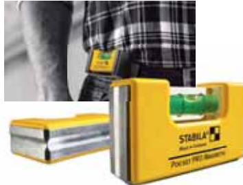
NIVEL DE BOLSILLO STABILA POCKET LEVEL PROFESSIONAL 70 x 20 x 40 mm. Precisión: +/- 1 mm/m. Nivelaciones horizontales y verticales. Dos superficies de nivelación fresadas en ángulo de 90° con ranura en V para tubos. Imanes de neodimio de alta potencia. Precisión permanente. CON FUNDA CINTURÓN. Made in Germany.
