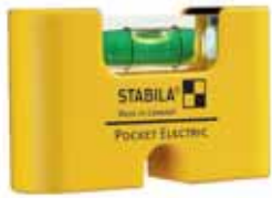
NIVEL DE BOLSILLO STABILA POCKET LEVEL ELECTRIC 70 x 20 x 40 mm. Precisión: +/- 1 mm/m. Imán de neodimio de alta potencia. Acceso para atornillar los mecanismos. Precisión permanente. Made in Germany. ESPECIAL ELECTRICISTAS.
