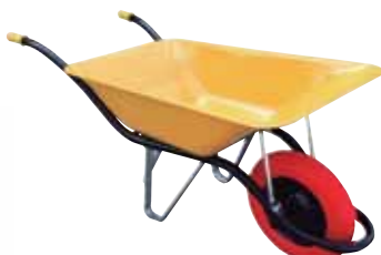
CARRETILLA EUROPA FERMAR 90 l. Bandeja de acero embutida en una sola pieza y bordes redondeados. Chasis tubular diámetro 32 x 1,6 mm. Patas y refuerzos en espesor 2,5 mm. Rueda rellena de espuma anti pinchazos. Llanta de acero color negro. Amarilla.
