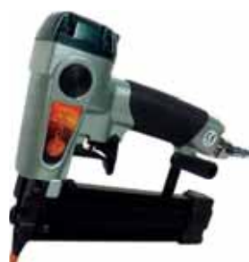
CLAVADORA NOVA 6/30 P UNICAIR Clavadora de 0,6 mm con y sin cabeza. De 15 a 30 mm sin cabeza y 15 mm a 30 mm con cabeza. Fijación de molduras y marcos, tapa juntas, decoración en muebles, etc.
